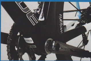
L'aspect massif du boîtier de pédalier n'est pas sans rapport avec la très grande rigidité du cadre, mais sa morphologie conditionne un écoulement "laminaire" des flux.
